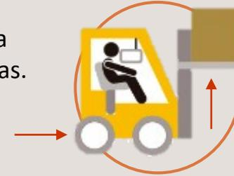
Nunca subas o bajas carga con el montacarga en movimiento, solo debes realizar **un movimiento a la vez**.
