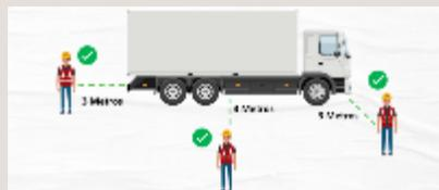
Antes de realizar algún movimiento con el camión, asegúrate de validar que alrededor del vehículo no exista ninguna persona a menos de 3 metros de distancia.
