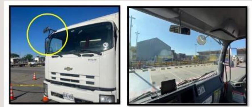
**3. Punto Ciego Frontal** Aunque no tan común como los puntos ciegos laterales y traseros, los vehículos cuenta con un punto ciego en el área delantera debido al diseño de la cabina o al tamaño del capó. Esto puede dificultar la visibilidad de objetos o peatones cercanos al frente del camión.
