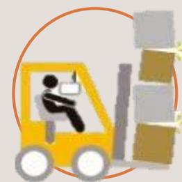
No se debe transportar cargas inestables. Se debe mantener la carga lo más cercana posible e la torre del montacarga.
