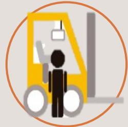
Antes de comenzar a operar el montacargas verifique que cuenta con :EPP, extintor, espejos, torreta, claxon operativo, alarma de retroceso y la verificación de la capacidad máxima del montacarga a manipular.
